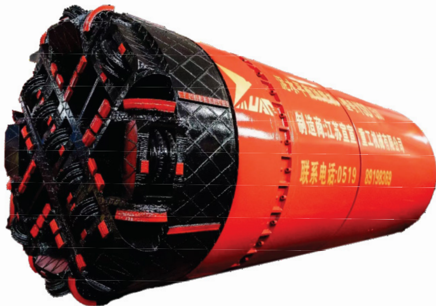
Microtunnelier type roche
