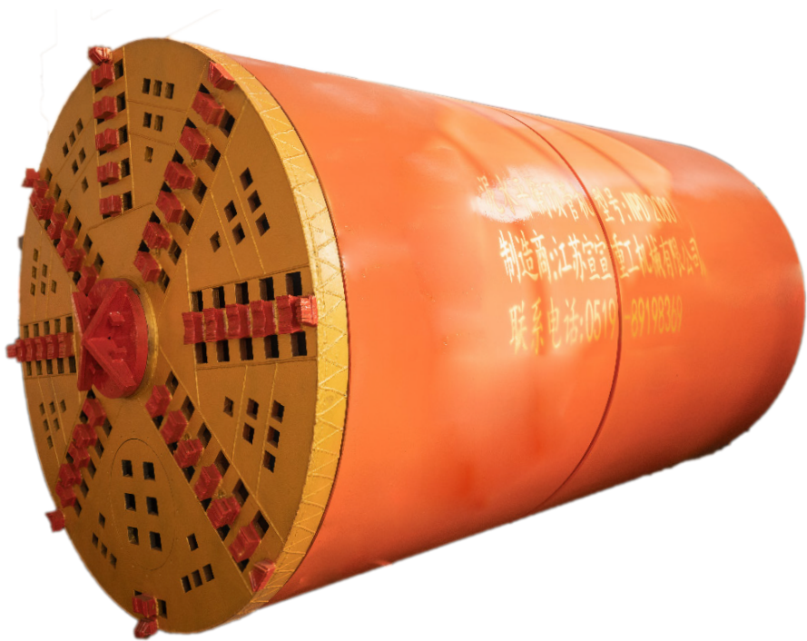
Microtunnelier type terrain meuble: Argile, Sable, Gravier
